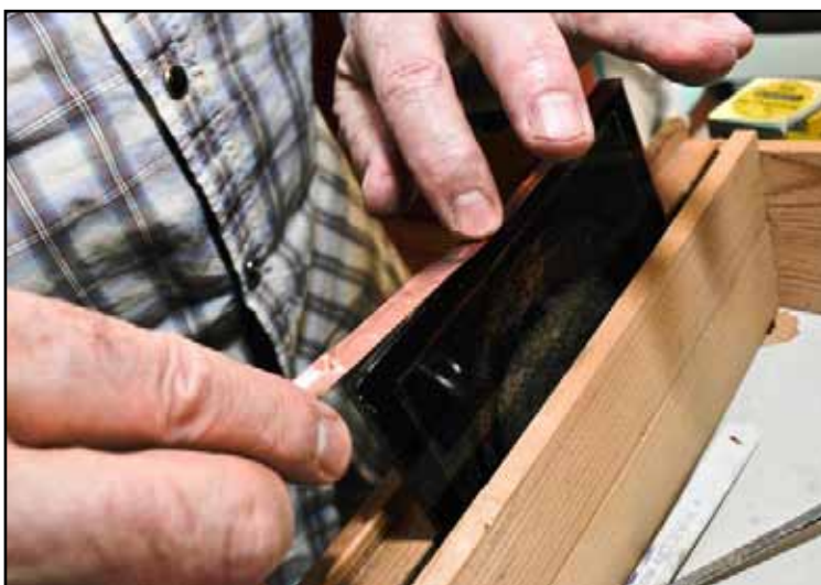
Montering med kopparfolie och lödning
